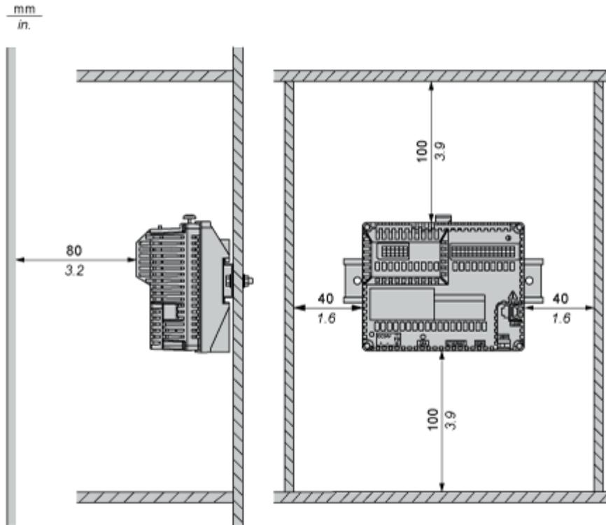
Deje el espacio necesario para garantizar una ventilación correcta con el objetivo de mantener una temperatura ambiente de 0-50 °C (32-122 °F) para la instalación horizontal y de 0-40 °C (32-104 °F) para la instalación vertical.
