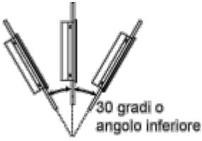
Bei der Montage einer Schalttafel in schräger Position mit einer Neigung von mehr als 30° darf die Umgebungstemperatur 40°C (104°F) nicht übersteigen. Gegebenenfalls müssen Sie eine Gebläseluftkühlung (Ventilator, Klimaanlage) einsetzen, damit eine Umgebungsbetriebstemperatur von höchstens 40°C (104 F) gewährleistet ist.
