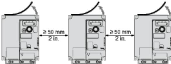
Für den Betrieb bei einer Umgebungstemperatur über 50 °C (122 °F)
