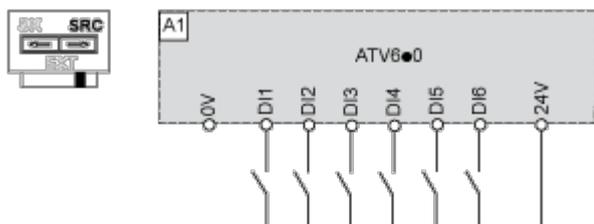
**Schalter in Stellung „SRC (Quelle)“ und Verwendung einer externen Versorgung für die Digitaleingänge**
