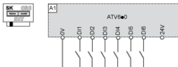
**Schalter in Stellung „EXT“ bei Verwendung einer externen Versorgung für die Digitaleingänge**
