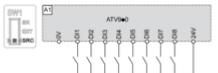
**Schalter in Stellung „SRC (Quelle)“ und Verwendung einer externen Versorgung für die Digitaleingänge**
