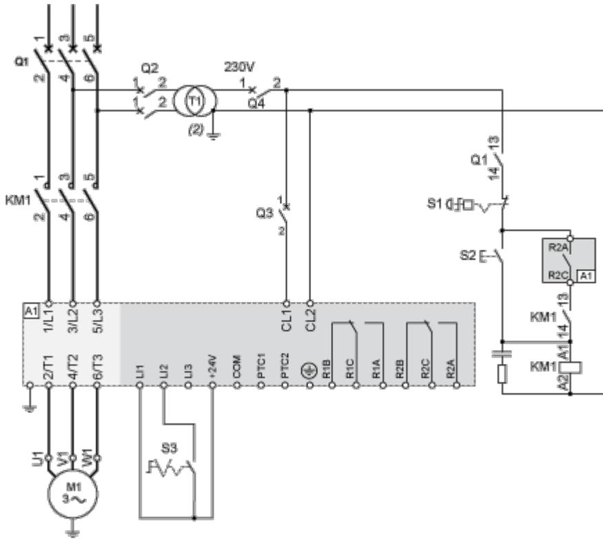
Connexion dans le couplage triangle du moteur, en série avec chaque enroulement
