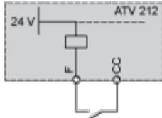
Position "PLC" avec sorties transistor de l'automate
