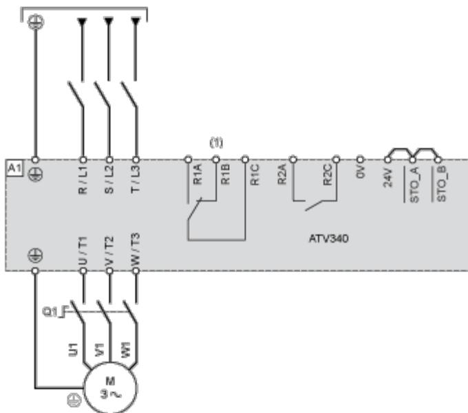
(1) Utilisez la sortie relais R1 réglée sur l'état de fonctionnement Défaut pour mettre l'appareil hors tension lorsqu'une erreur est détectée.
