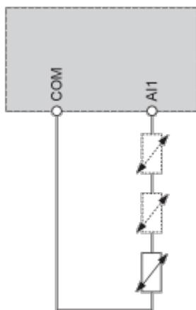
Il est possible de raccorder 1 ou 3 capteurs sur les bornes AI1.
