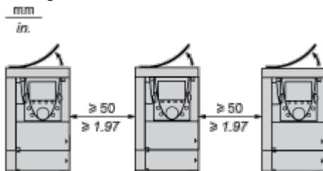
En ôtant l'obturateur de protection au-dessus du variateur, le degré de protection de ce dernier devient IP 20. L'obturateur de protection peut être différent selon le modèle de variateur (voir guide utilisateur).
