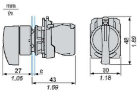
e : épaisseur du dispositif de serrage : 1 à 6 mm / 0,04 à 0,24 pouce
