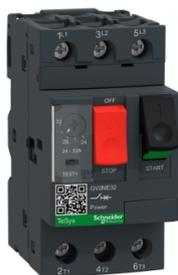
Interruttore automatico magnetotermico GV2ME con controllo a pulsante e range regolazione protezione termica da 24 A a 32 A, 3P, connessione a vite
