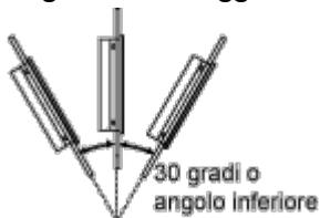
Quando si installa il pannello in posizione obliqua con inclinazione maggiore di 30°, la temperatura ambiente non deve superare 40 °C (104 °F). Potrebbe essere necessario l'uso di aria di raffreddamento forzata (ventilatori, A/C) per assicurare che la temperatura ambiente sia al massimo 40°C (massimo 104°F).
