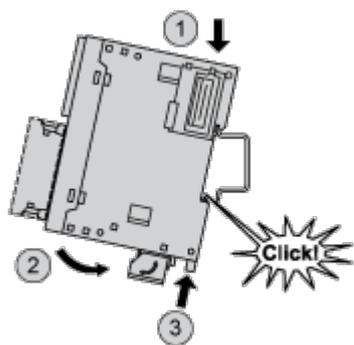
Montaggio diretto sulla superficie di un pannello
