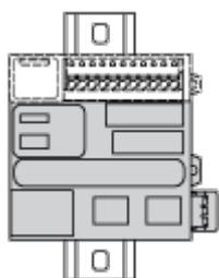
**Posizione di montaggio errata**
