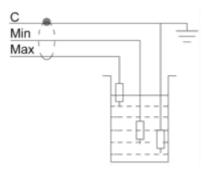
A1,A2 : Supply voltage Max : High level Min : Low level
