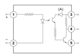
1,2 : Field VDC 3 : Vcc 4 : Logic 5 : Ground (A) LED
