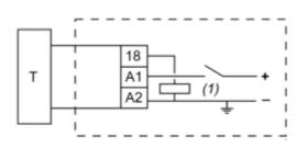
T : Timer (1) Load A1 - A2 : Supply (24VDC)
